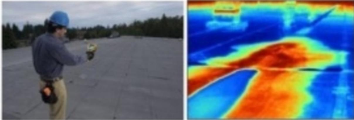
Рис. 5.: Обследование плоской кровли с помощью тепловизора. На тепловизионном изображении справа четко видны отдельные участки, указывающие на влажную теплоизоляцию, которая за день значительно нагревается от солнечного излучения. Вода, находящаяся в кровле, имеет очень высокую теплоемкость и поглощает тепло гораздо больше остальных материалов.
